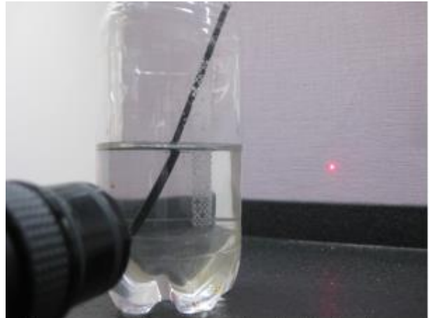
Abb. 1: Der Stab im Wasser zeigt die Lichtbrechung. Der Laserstrahl zeigt an der Wand eine kreisförmige Abbildung.
