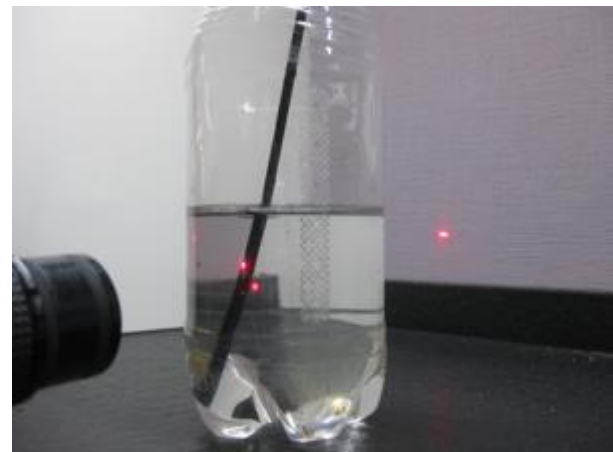
Abb. 2: Der Laserstrahl geht durch die Flasche mit dem Wasser. Der Lichtpunkt wird teilweise reflektiert und zeigt an der dahinterliegenden Wand eine längliche Form.
