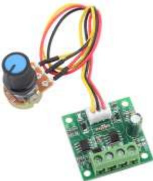
DC Motor Drehzahlregler, 1,8V bis 15V 2A PWM Motor Drehzahlregler
